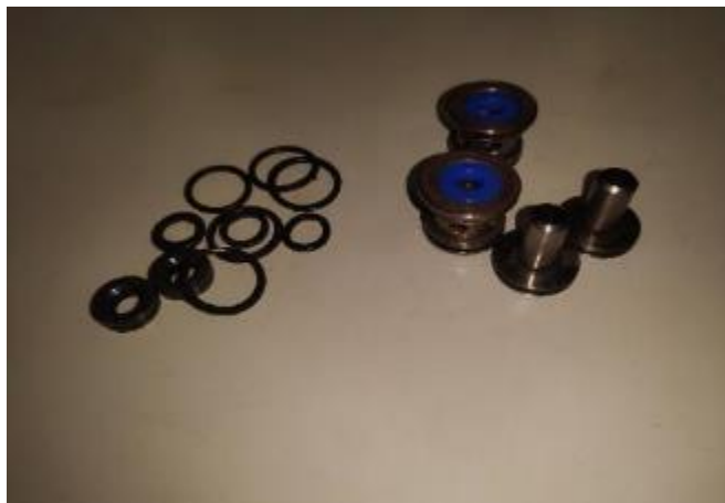
Gambar 3.3 Pilot valve yang tersumbat
