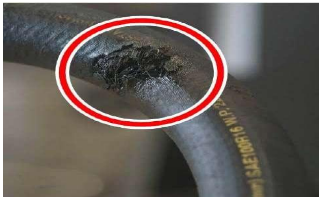
Gambar 3.1 Selang Hidrolik Pecah
